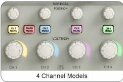
Figure 3.1: TDS1012B and TDS2024B VERTICAL control section
