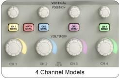
Figure 2.8: TDS1001B and TDS2024B VERTICAL controls
