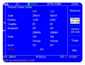
Figure 6.16: TDS1000B/TDS2000B Vertical System Status display
