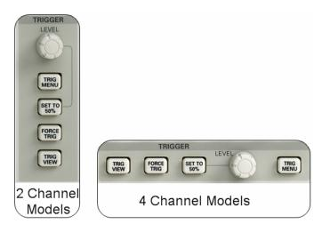
Figure 2.13: TDS1012 and TDS2024 TRIGGER controls
